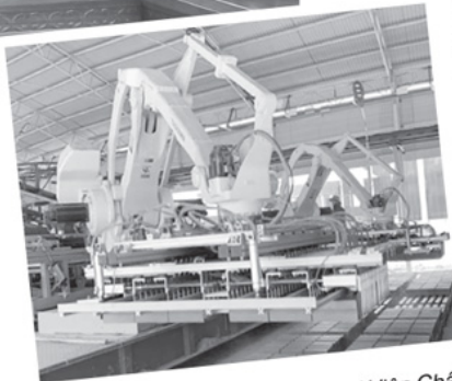
Công ty cổ phần Gạch Tuynel Viên Châu sử dụng hệ thống robot xếp gạch tự động.
