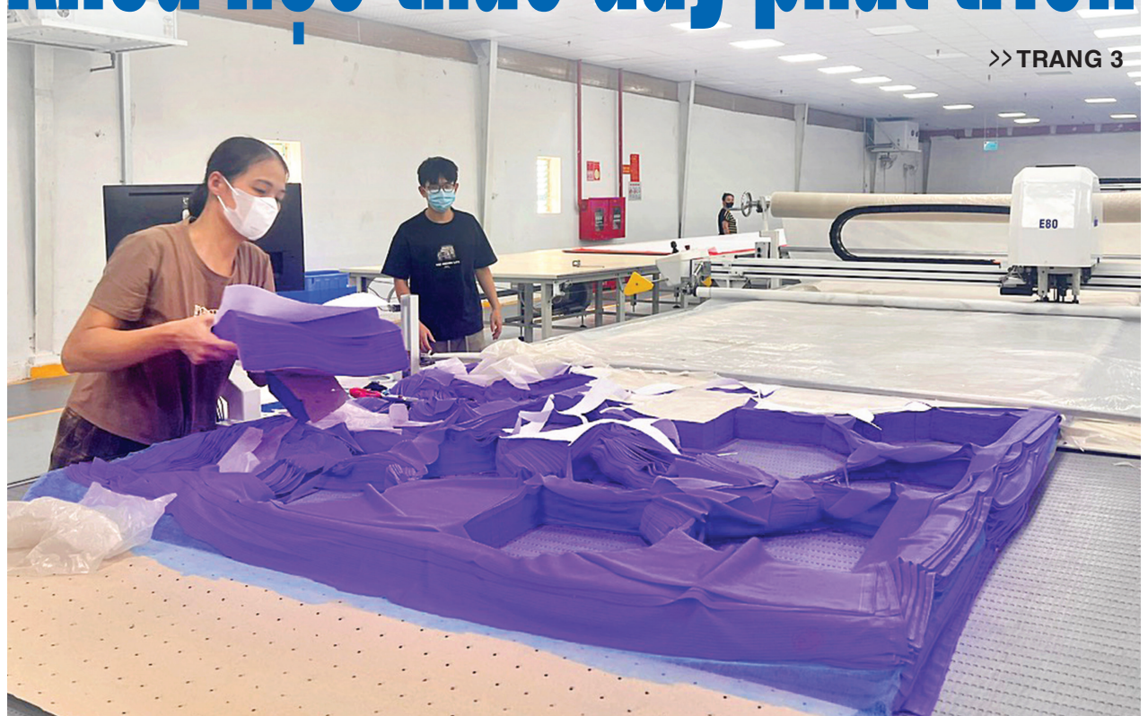
Công ty TNHH Thương mại, xuất nhập khẩu may mặc Độc Mỹ (Khu Công nghiệp Bình Vàng - xã Vị Xuyên), ứng dụng tiến bộ khoa học kỹ thuật, sử dụng robot tự động cắt, định hình sản phẩm.
