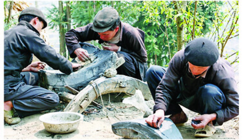
Công đoạn rót gang vào khuôn đúc đòi hỏi sự khéo léo và chính xác để tạo nên phối lưỡi cày đạt chất lượng (ảnh trái). Trước mùa vụ mới, các lò rèn của người Mông lại nhộn nhịp đúc lưỡi cày (ảnh phải).
