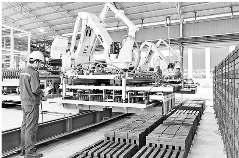
Công ty cổ phần Gạch Tuynel Viên Châu dùng cánh tay robot gấp gạch.
